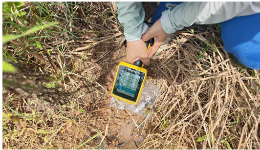
11# XRF 检测（河道边坡）
